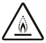
Advertencia: material de baja velocidad de combustión (Para productos que contienen refrigerante R32, cumplir con la norma IEC 60335-2-40:2018 únicamente)
